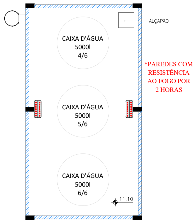
2 PLANTA - CAIXA D'ÁGUA NÍVEL 11,10 ESCALA 1:100
