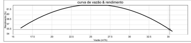
**1 ESQUEMA DA CURVA HIDRÁULICA**
