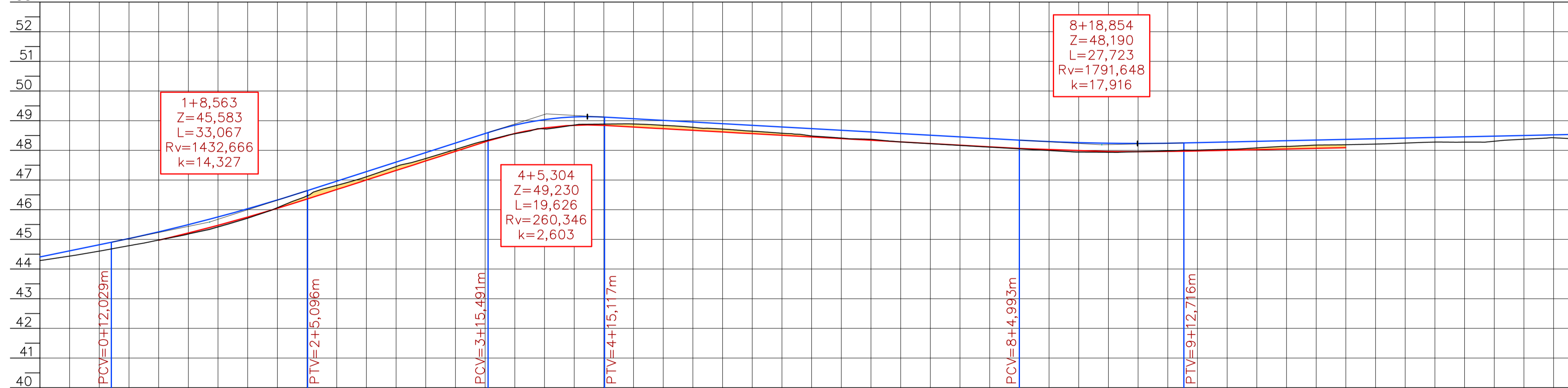
53 PERFIL LONGITUDINAL - ALINHAMENTO BARRA NEGRA
